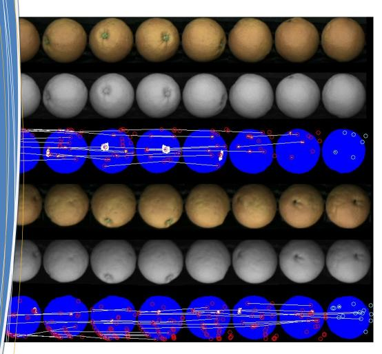
El módulo de visión artificial funciona mediante la utilización de dos o cuatro cámaras por línea, capturando hasta 32 imágenes de un mismo fruto con las dos cámaras RGB y las dos IR desde dos ángulos diferentes, lo que asegura más de un 95 % de efectividad en la detección de defectos externos.
